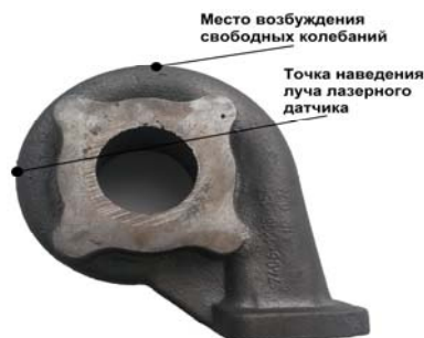
Рис. 5. Точка наведения луча лазерного датчика и место возбуждения свободных колебаний на заготовке корпуса турбины турбокомпрессора
