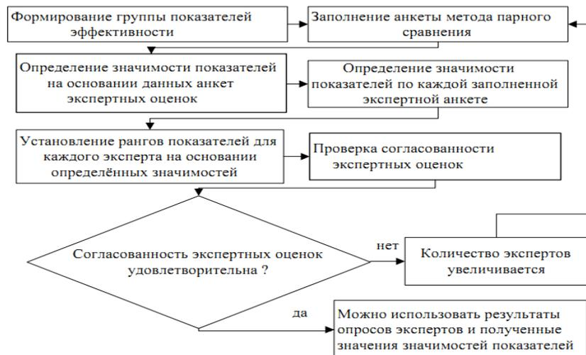
Рис. 2. Блок-схема определения значимости показателей надежности парным способом сравнения
