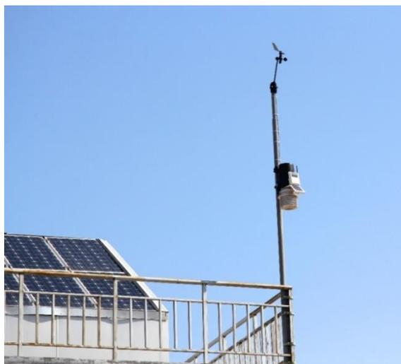
Рис. 4. Метеорологическая станция марки *Davis Vantage Pro2 Plus* установленная в самостоятельно энергообеспечивающемся испытательном доме Государственного энергетического института Туркменистана (ГЭИТ)
