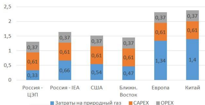
Рис. 3. Стоимость производства водорода из природного газа с учетом затрат на улавливание, хранение и утилизацию углекислого газа (CCUS), долл./кг [9]
