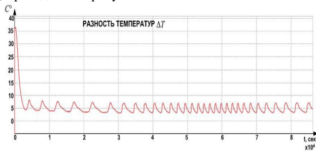
Рис. 10 График, отражающий колебание разности температур, зафиксированных датчиками перед теплообменником и после него
