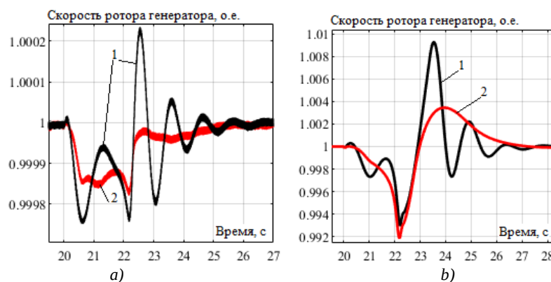
Рис.7. Временные зависимости скорости вращения ротора генератора ТГУ при пуске мощного эквивалентного АЭД: а) – полная схема ИСЭС (НЭ включен); б) – НЭ отключен; 1 – у ТГУ использовался классический APC; 2 – у ТГУ использовался автопрогностический APC
