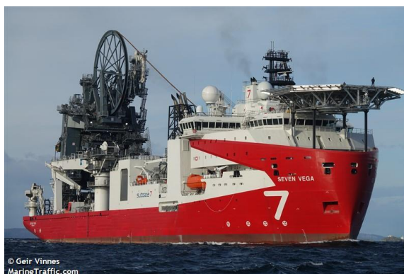
Рис.2. Кабелеукладчик «Seven Vega»
