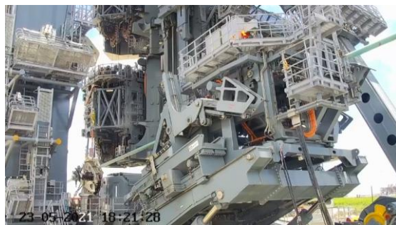
Рис.3. Натяжитель (тензионер) до аварии
