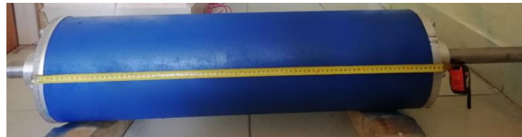
Рис. 2. Макетный образец тихоходного СДПМ для привода поршневого компрессора
