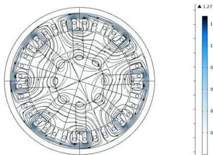
Рис. 4. Распределение магнитного поля в электродвигателе с ферритовыми магнитами. Fig. 4. Magnetic field distribution in ferrite magnet motor.
