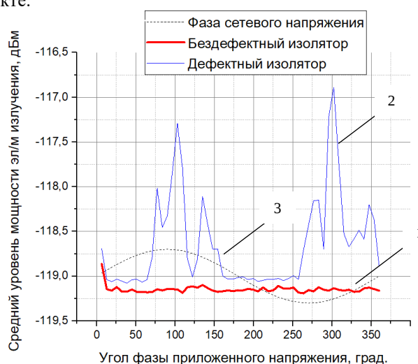
Рис.6. Синхронная фильтрация среднего уровня мощности электромагнитного излучения в течение 15 минут (45000 периодов напряжения) относительно фазы приложенного напряжения у бездефектного и дефектного изоляторов. 1 – бездефектный изолятор, 2 – дефектный изолятор, 3 – фаза сетевого напряжения.
