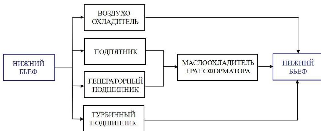
Рис.2. Схема системы охлаждения гидрогенератора
