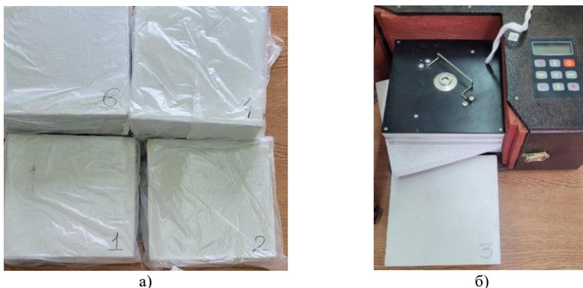
Рис. 2. Фотографии: а) исходных образцов композитного бетона, б) рабочего образца для измерителя теплопроводности
