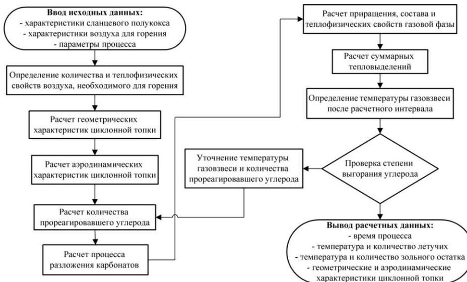
Рис. 2. Укрупненная блок-схема алгоритма расчета циклонной топки
