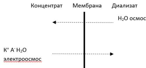
Рис. 1. Направление движения потоков воды при осмосе и электроосмосе
