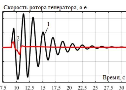
Рис. 8. Скорость вращения ротора генератора при кратковременном КЗ: обозначения 1 и 2 соответствуют рис.7
