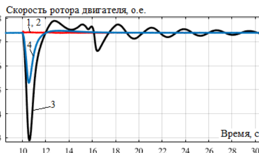
Рис. 5. Изменение скорости ротора двигателя при отключении основного питания: обозначения 1, 2, 3 и 4 аналогичны рис.3
