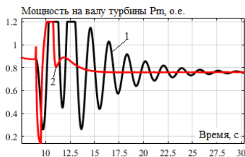
Рис. 7. Механическая мощность на валу турбогенератора при кратковременном КЗ: 1 – регуляторы без прогнозирующего звена; 2 – СПАРВ и СПАРЧВ
