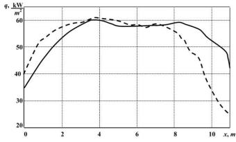
Рис. 6. Изменение поверхностных плотностей Fig. 6. Distribution of surface densities of heat fluxes теплового излучения по высоте трубчатого along the height of the tubular screen экрана
