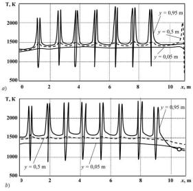
Рис. 3. Характер изменения температуры газов по высоте камеры радиации на разных расстояниях y от пирозмеевиков: a – в левой половине камеры; b – в правой половине;  $\mathbf{O}$  – температура дымовых газов на выходе из камеры радиации, измеренная по датчикам действующей установки
