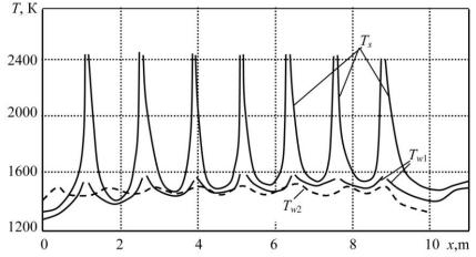
Puc. 4. Температура внутренней поверхности Fig. 4. The temperature of the inner surface of the боковых футеровок камеры side linings of the camera
