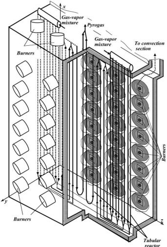
Puc. 1. Схема части радиационной камеры Fig.1. Scheme of a part of the radiation chamber of a трубчатой печи пиролиза углеводородов tubular hydrocarbon pyrolysis furnace.
