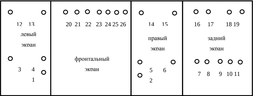
Рис. 1. Схема расположения лючков на котле ТГ-104
