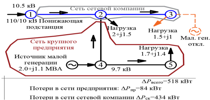
Рис. 2. Исходная конфигурация тестовой распределительной сети
