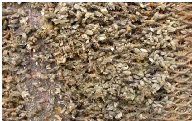
Рис.15. Биологические обрастания на решетке *Fig.15. Biological fouling on the grill of the fish protection device of a thermal power plant*
