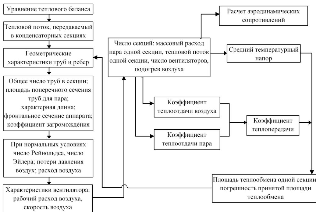
Рис. 3. Блок-схема методики расчета Fig. 3. Flow chart of the calculation method for the condenser sections of an Air-Cooled Condenser\*
