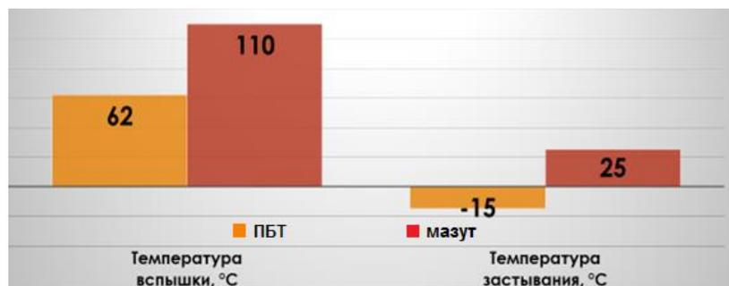
Рис. 2. Температура вспышки и температура застывания (°C) для мазута и печного бытового топлива
