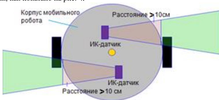
Рис. 4. Пример установки ИК-датчиков на корпусе МР Fig. 4. An example of installing IR sensors on the MR body
