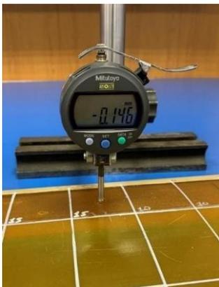
Рис.6. Замер глубины повреждения
