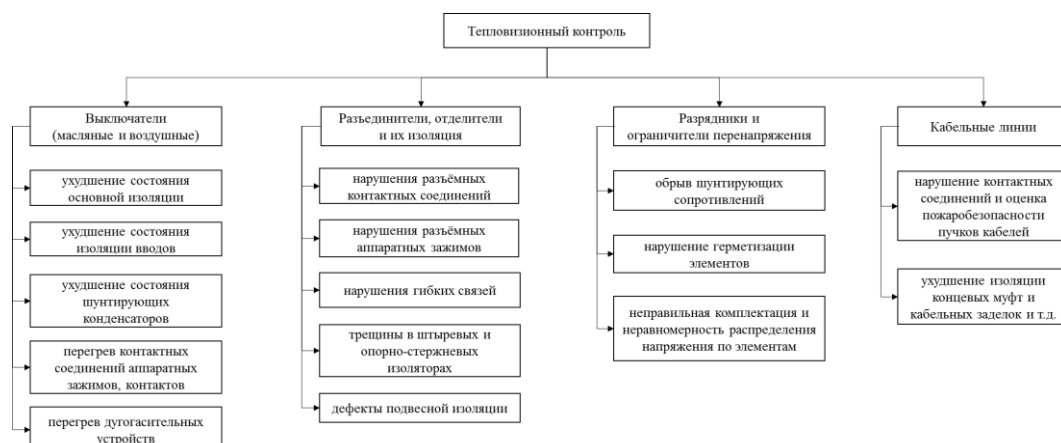
Рис. 1. Виды неисправностей в контактных системах аппаратов и кабелей
