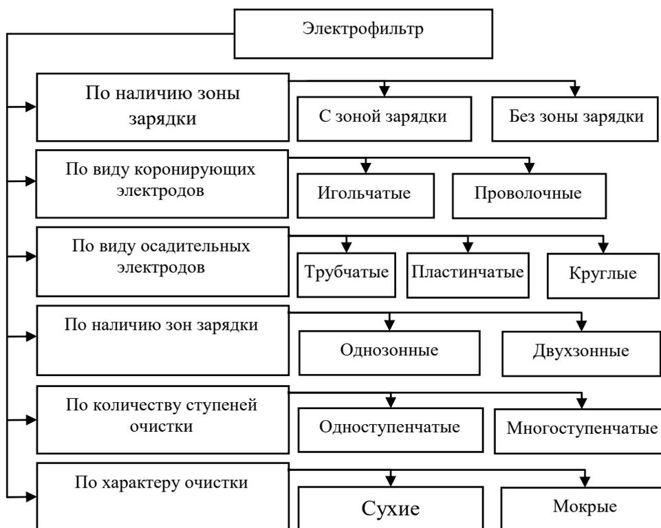
Рис. 4. Классификация электрофильтров
