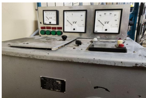
Рис. 3. Установка миллиамперметра в приборную панель АИИ-70 Fig. 3. Installation of a milliammeter in the АИИ-70 dashboard
