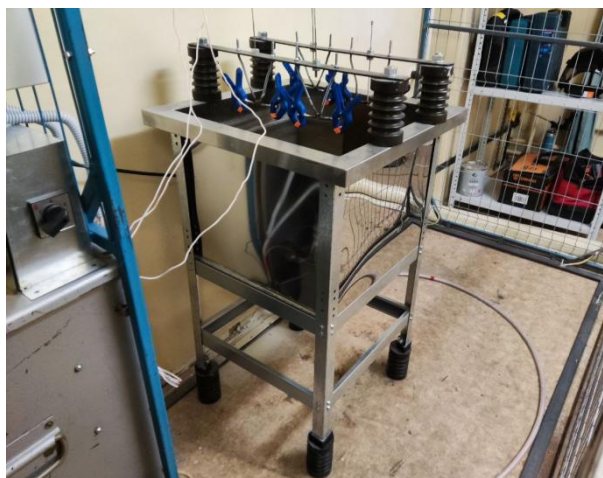
Рис. 4. Ванна для испытания перчаток, галош, бот и других СИЗ Fig. 4. Bath for testing gloves, galoshes, boots and other personal protective equipment
