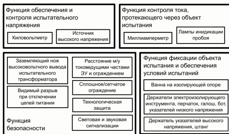
Рис. 1. Функциональная схема УИСИЗ
