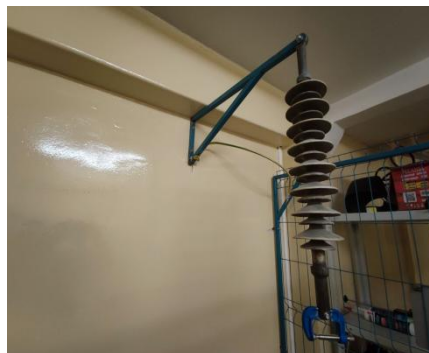
Рис. 5. Крепление для испытания штанг и указателей высокого напряжения Fig. 5. Mounting for testing rods and high voltage indicators
