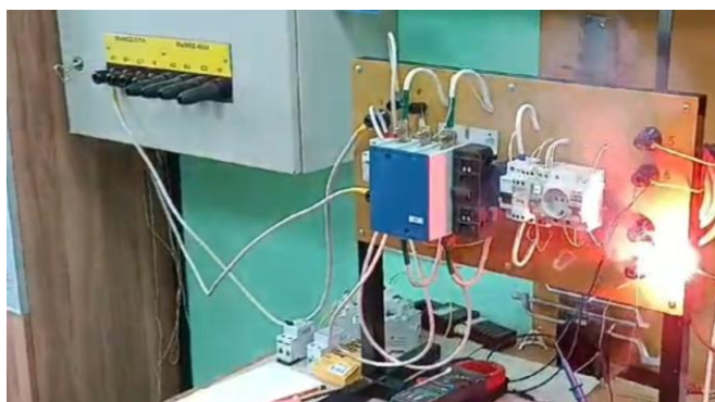
Рис. 7. Параллельный дуговой пробой на землю на образце кабеля
