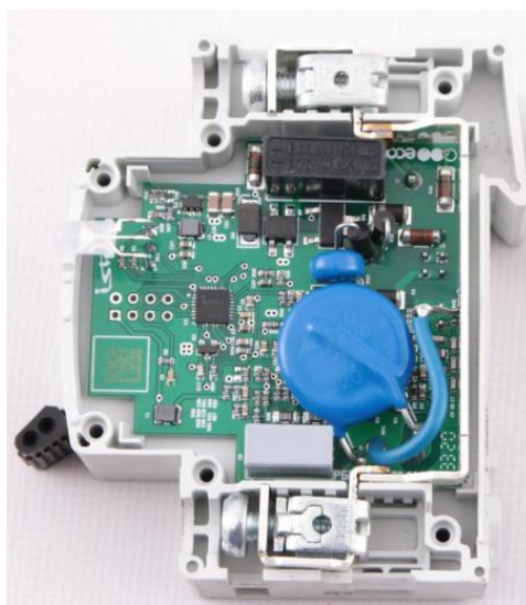
Рис. 3. Блок обнаружения дугового пробоя Fig. 3. Arc fault detection unit
