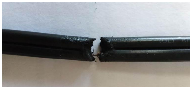
Рис. 8. Образец кабеля после завершения параллельного дугового пробоя на землю
