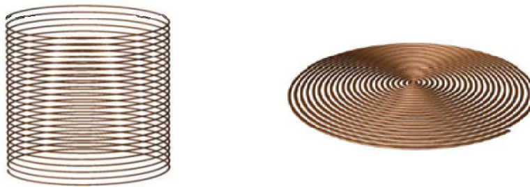
Рис. 2. Цилиндрическая и плоская спиральная катушки индуктивности, применяемые в качестве датчиков в ЯКР установке
