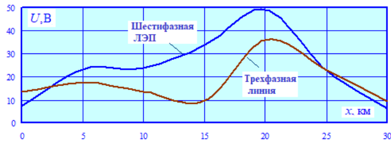
Рис. 2. Наведенные напряжения в симметричном режиме при нагрузках на приемном конце 100 + j50 МВ·А на фазу: x – координата оси параллельной трассе ЛЭП
