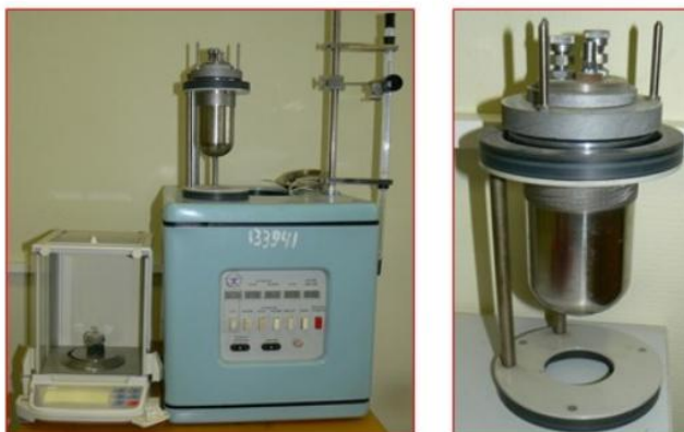
Рис. 5 Лабораторная калориметрическая установка Fig. 5 Laboratory calorimetric setup
