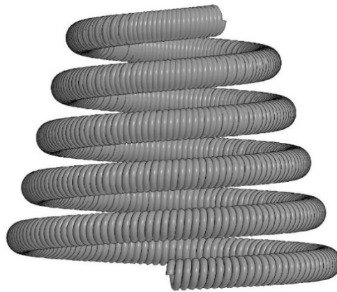
Рис. 1. Модель конического змеевикового пружинно-витого канала, построенная в SpaceClaim
