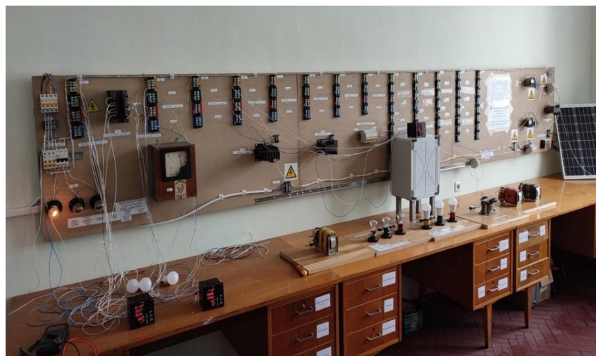
Рис. 2. Внешний вид реализации опыта обратной трансформации на разработанной физической модели
