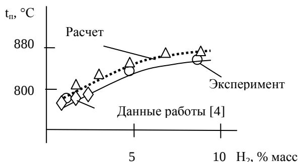
Рис. 1. Температура продуктов сгорания t_p на выходе из топки при содержании водорода в сжигаемой метано-водородной фракции
