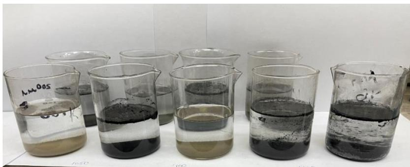
Рис. 7. Визуализация обогащения ЗШО угля и месторождений Монголии Fig. 7. Visualization of the enrichment of ash and slag waste from coal deposits in Mongolia
