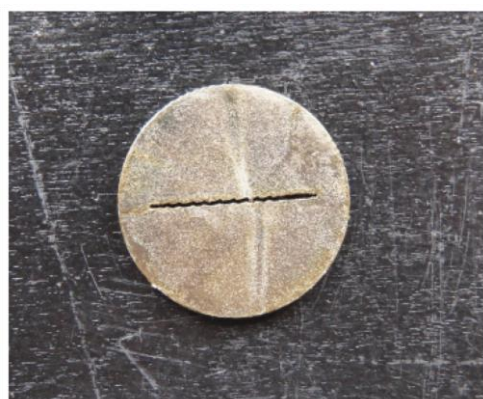
Рис. 5. Диск симуляции дефекта трещина
