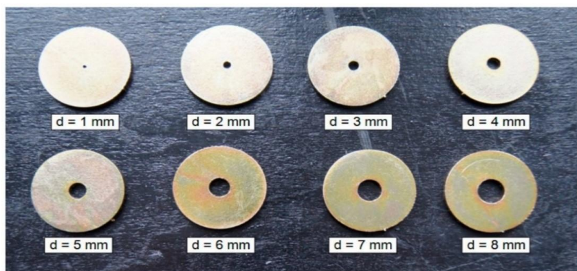
Рис.4. Диски симуляции дефекта отверстия разного диаметра
