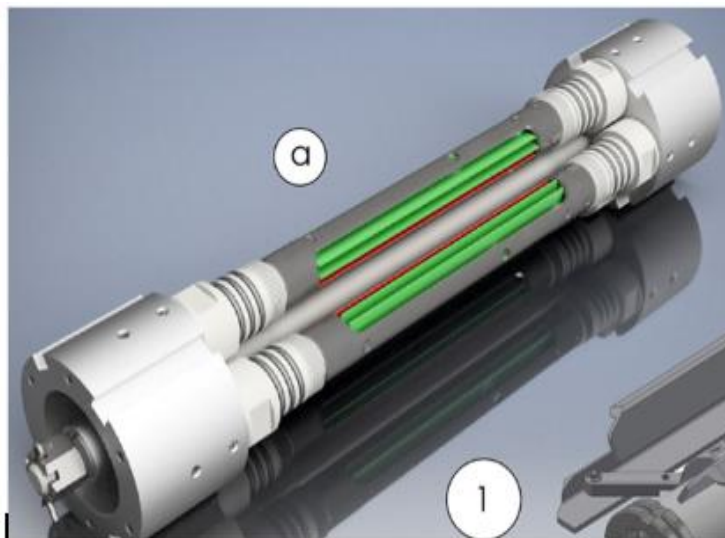
Рис. 3 – Тепловая герметичная камера с четырьмя блоками измерительных устройств
