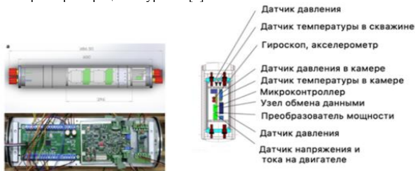
Рис. 1 – Внешний вид и расположение элементов в тепловой камере
