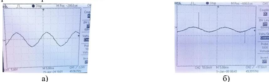
Рис.5. Осциллограммы ЧР в масляной ячейке при  $U_{rms}=24$  кВ: а) контрольный образец изоляции без дефекта; б) изоляция с воздушным дефектом 0,3 мм вдоль поля
