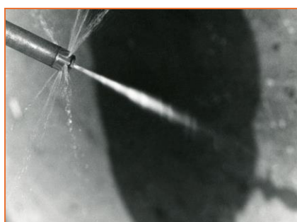
Рис. 9. Структурная спиновая детонация факела с вздутием струи на конечном участке Fig. 9. Structural spin detonation of the plume with jet implosion at the end section
