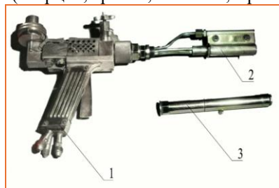
Рис. 1. Установка, выполненная в виде огнеструйной горелки ракетного типа 1. Камеры сгорания и сверхзвукового сопла 2. Охлаждение – КПП
