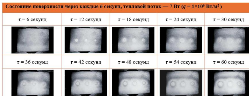
Рис. 13. Голографические интерферогаммы Fig. 13. Holographic interferograms of the покрытия из мрамора marble coating
