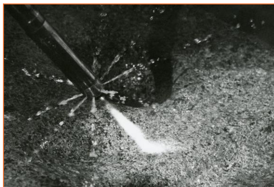
Рис. 10. Взаимодействие детонационного факела с гранитной поверхностью
