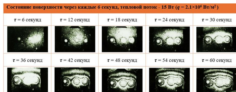
Рис. 11. Голографические интерферограммы покрытия из туфа
