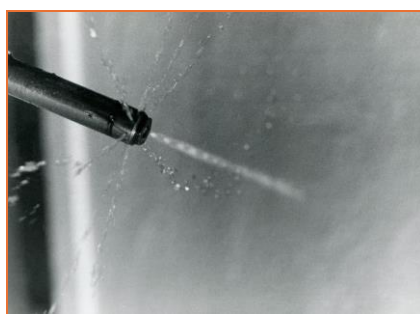
Рис. 8. Зарегистрирована структурная спиновая детонация факела (восемь участков) Fig. 8. Structural spin detonation of the plume (eight sites) recorded
