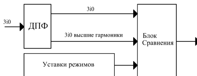
Рис. 10. Упрощенная структурно-функциональная схема пускового органа защиты на основе токов гармоник
