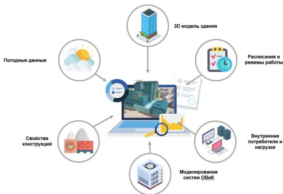
Рис. 1. Основные этапы создания энергетической модели Fig. 1. The main stages of creating an energy model
