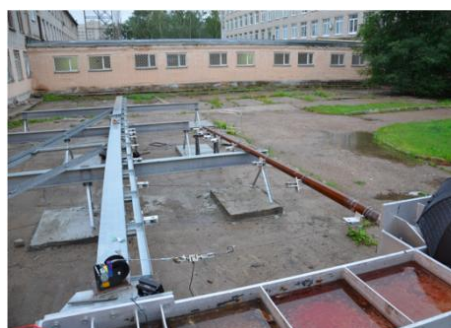
Рис.10. Испытание опоры ОГК-7 на стенде ИС-1 (Испытательный полигон КГЭУ, июль 2015г.)
