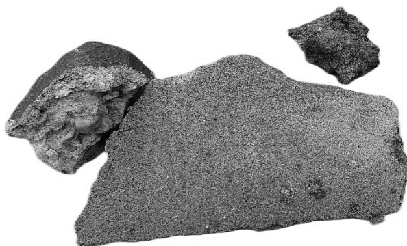
Рис. 2. Агломераты, обнаруженные в донной золе котлоагрегата Е-75-3,9-440 ДФТ
