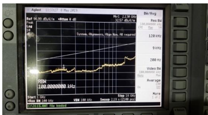
Рис. 13. Напряженность электромагнитного поля радиоизлучения от изделия на частоте 18 ГГц
