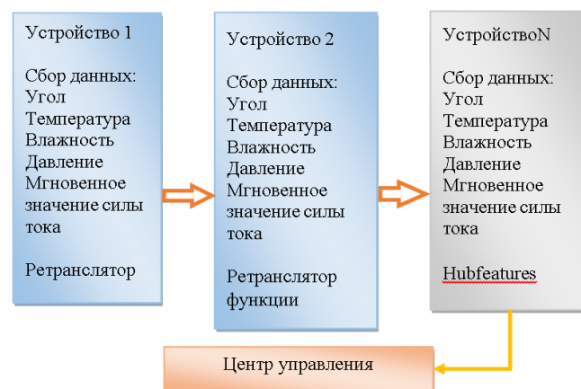
Рис. 2. Структура системы мониторинга состояния ВЛ.
