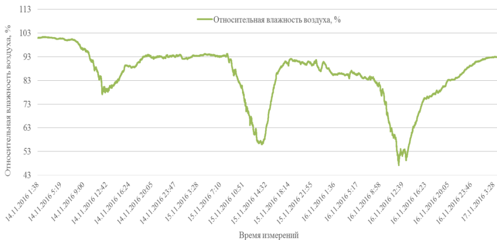
Рис. 5. Показания относительной влажности воздуха с устройства, установленного на линии напряжением 35кВ.
