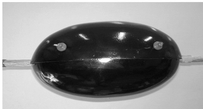
Рис. 6. Внешняя оболочка устройства мониторинга и количественного контроля гололёдообразования на ВЛ.
