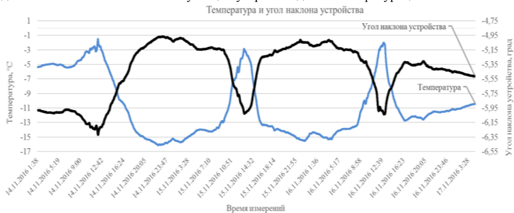
Рис. 4. Показания температуры провода и угла наклона устройства установленного на линии напряжением 35кВ
