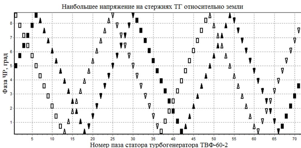
Рис. 2. Распределение напряжения в пазовой части ТВФ-60-2
