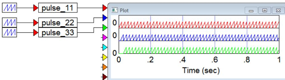
Рис. 6, а. Пилообразные импульсы в трехфазном режиме в пакете *VisSim*
