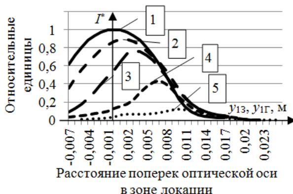
Рис. 4. Зона локации поперек оптической оси при поперечной ( $\Delta y$ , %) разьюстировке (радиус антенны 50 мм, оптическая система без aberrаций, ширина спектра  $\Delta \nu = 10$  кГц,  $S'_3 = S'_r = 100$  м): 1 – 0%; 2 – 35%; 3 – 50%; 4 – 75%; 5 – 100%;  $y_{13, Г}$  – координата поперек оптической оси для зондирующего и опорного (гетеродинного) каналов;  $I^*$  – интенсивность интерференции излучений опорного и зондирующего каналов в пространстве изображений
