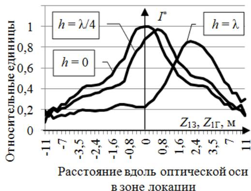
Рис. 2. Зона локации вдоль оси на дистанции 100 м (радиус антенны 50 мм, абберации одного знака и модуля для обоих каналов, ширина спектра  $\Delta\nu = 10$  кГц):  $h$  – волновая абберация оптической системы;  $\lambda$  – длина волны излучения;  $Z_{13, \Gamma}$  – координата вдоль оптической оси для зондирующего и опорного (гетеродинного) каналов;  $I^*$  – интенсивность интерференции излучений опорного и зондирующего каналов в пространстве изображений
