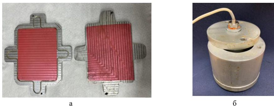
Рис. 1. Металлические оснастки для вспенивания: Fig. 1. Metal mold tool for foaming: a – rectangular mold tool t; b – cylindrical mold tool with a pressure sensor а – оснастка прямоугольной формы; б – цилиндрическая оснастка с датчиком давления
