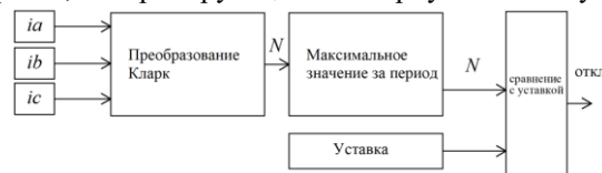
Рис. 6 Упрощенная структурно-функциональная схема пускового органа защиты на основе вектора N Fig. 6. Simplified functional block diagram of the starting element based on vector N
