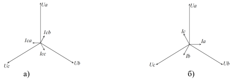
Рис. 2. Векторные диаграммы токов и напряжений кабельной линии в нормальном режиме. а) Напряжения и емкостные токи в нормальном режиме; б) Напряжения и индуктивные токи нагрузки в нормальном режиме
