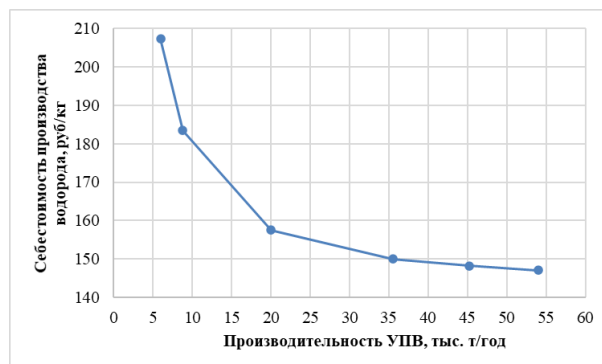
Рис. 6. Зависимость себестоимости производства водорода от производительности установки
